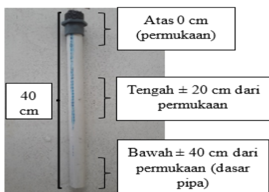
Gambar 1. Skema alat sampling tanah muara
